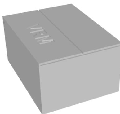
Объекты манипулирования различных цветов. Каждого по 3 шт. Детали имеют одинаковые длину и ширину, а также метку, видимую датчиком на конвейере за счет чего свободно умещаются в накопителе заготовок.
