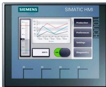
В комплект входит ПЛК SIEMENS 1200 серии, HMI панель диагональю 7 дюймов и расширение по 16 цифровых входов и выходов.
